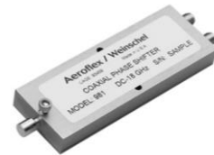
フェイズシフタ 周波数帯域：DC~40GHz 挿入損失：0.5-6.8dB # プログラマブル版有り
