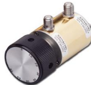
可変アッテネータ 減衰域：1dB~114dB ステップ：1dB,10dB 周波数帯域：DC~26.5GHz 耐電力：500W
