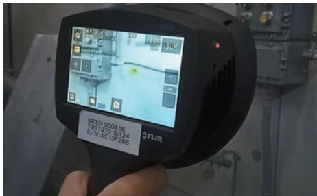
FLIR Si124は音響カメラでは珍しいガンタイプで片手操作式
