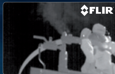
一酸化炭素漏れの光学ガス画像
