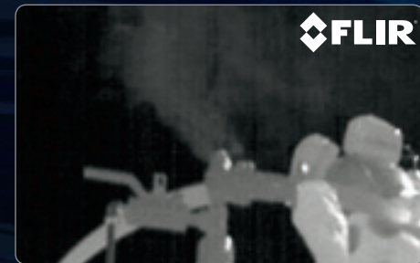
六フッ化硫黄漏れの光学ガス画像
