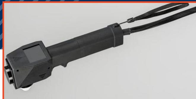
T-Ray® 5000 SPG SPGシングルポイント厚さ測定ゲージは、ボタンを押すだけで対象物の複数の層を直接測定することができます。測定ツールはモジュール式であるため、ストレート又は直角の測定チップを使用できます。測定は基本的に非接触ですが、測定チップはハンドヘルド使用において、ユーザがTHzビームの焦点に測定対象物を位置決めするのを助けるために使用されます。使い易いタッチスクリーンディスプレイは、測定の構成と動作モードの選択を可能にします。
